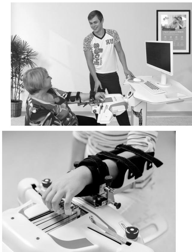
Рис. 1. Роботизированный реабилитационный комплекс с обратной связью Amadeo
