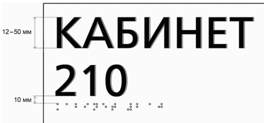
Рисунок 33 - Высота РЛШ при совмещении визуальной и тактильной информации (в данном случае знаки РТШ рекомендуется выполнять прозрачными или в цвет подложки)
