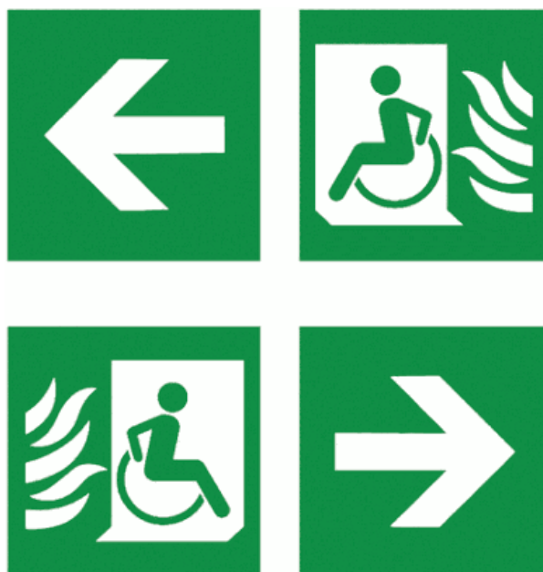
Рисунок 23 - Знак "Эвакуационные пути для инвалидов" ("Выход там")
