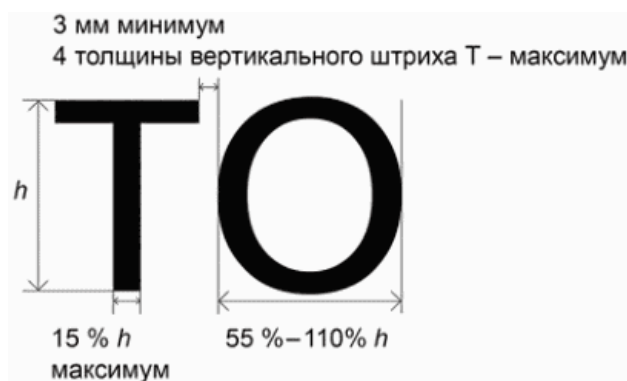
Рисунок 24 - Пропорциональные соотношения элементов шрифтовых знаков
